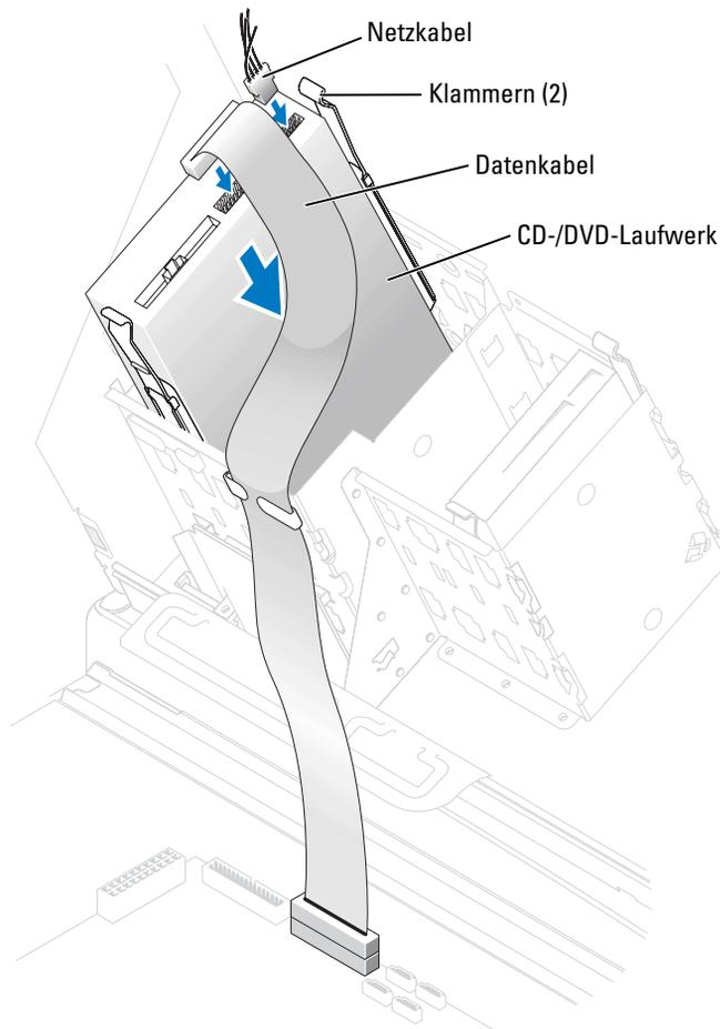
**6** Überprüfen Sie alle Kabelverbindungen und verlegen Sie die Kabel so, dass sie den Luftstrom für den Lüfter und die Kühlschlitze nicht behindern.
