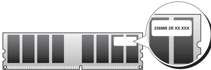
**ANMERKUNG:** Installieren Sie DDR2-Speichermodule immer in der Reihenfolge, die auf der Systemplatine angezeigt ist.
