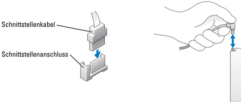
Die meisten Schnittstellenanschlüsse sind passgeformt, um ein korrektes Anschließen zu gewährleisten; diese Kodierung kann eine Kerbe oder ein fehlender Stift auf der einen Seite und eine Nut oder eine gefülltes Stiftloch auf der anderen Seite sein.
